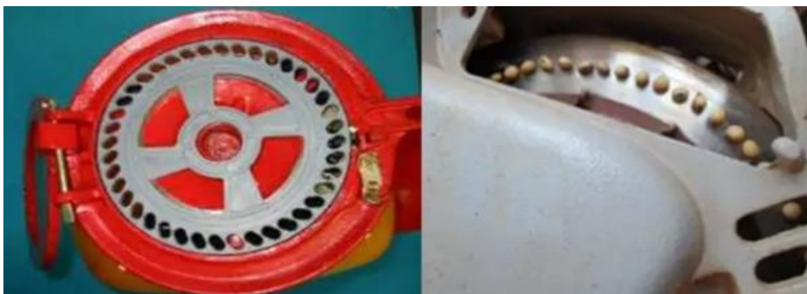
Figura 1. Dosador mecânico à esquerda e dosador pneumático à direita.
