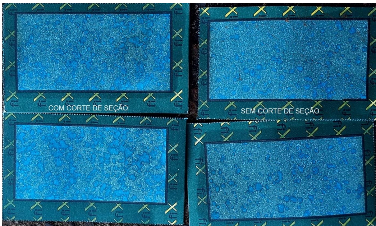
Figura 6. Papéis hidrossensíveis analisados com e sem sobreposição na cultura do feijão. Pitanga-PR, 2022.
