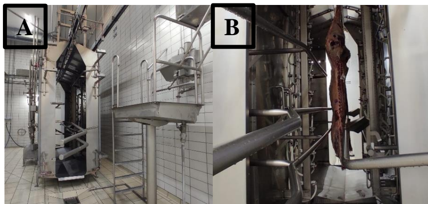
Imagem 10 - Equipamento de lavagem de meias carcaças - lavadora automática (10A) e equipamento de lavagem de meias carcaças com carcaça dentro da lavadora (10B).
