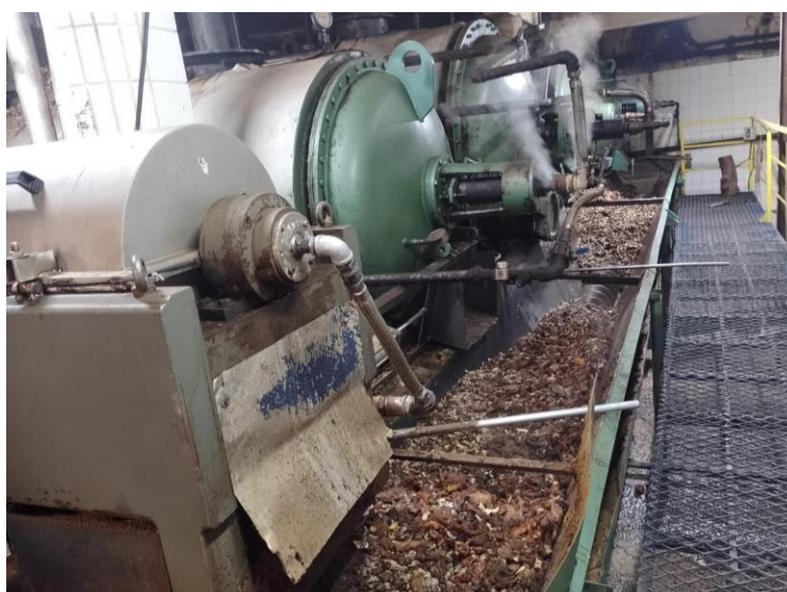
Imagem 15 – Digestores utilizados no processo de cozimento e percolador onde ocorre a separação da parte líquida e sólida. Fonte: MARCONDES, 2022.
