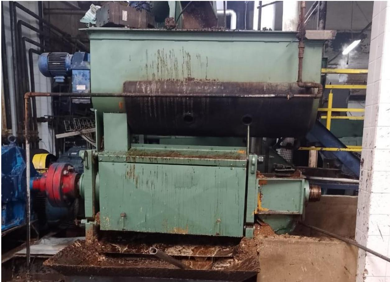
Imagem 16 – Prensa utilizada para retirar o restante do líquido da parte sólida.
