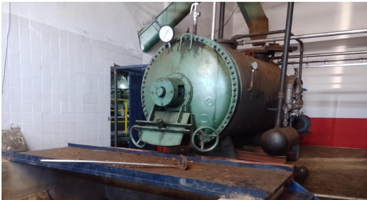
Imagem 18 – Esterilizador onde ocorre o tratamento térmico da farinha.
