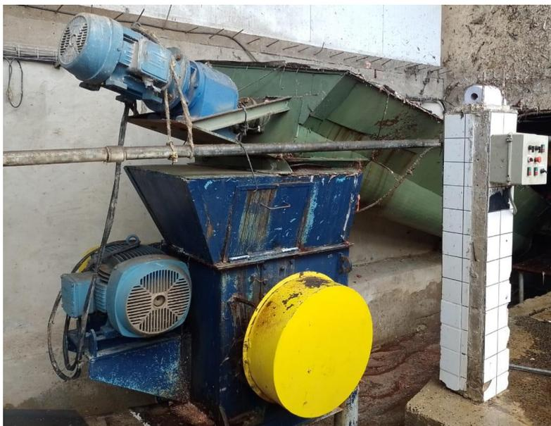
Imagem 14 – Quebrador de ossos utilizado para quebrar a matéria-prima em pedaços facilitando o cozimento.
